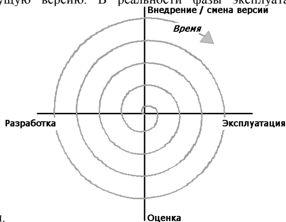
Рисунок 3 — Спиральный жизненный цикл информационной системы
