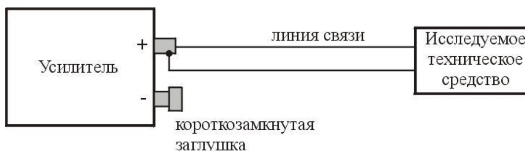
Рис. 2. Несимметричная схема подключения
