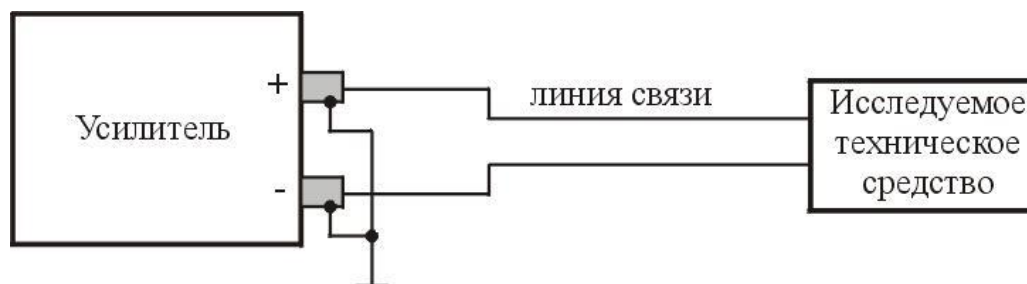
Рис. 1. Симметричная схема подключения
