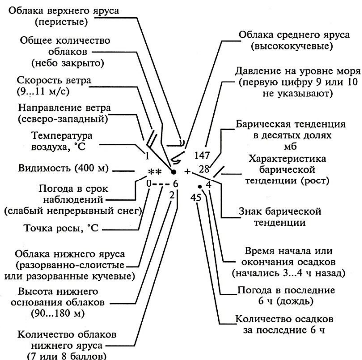
Рис. 6.2. Схема нанесения данных на синоптическую карту
