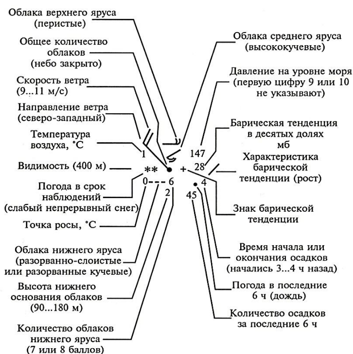
Рис. 6.2. Схема нанесения данных на синоптическую карту
