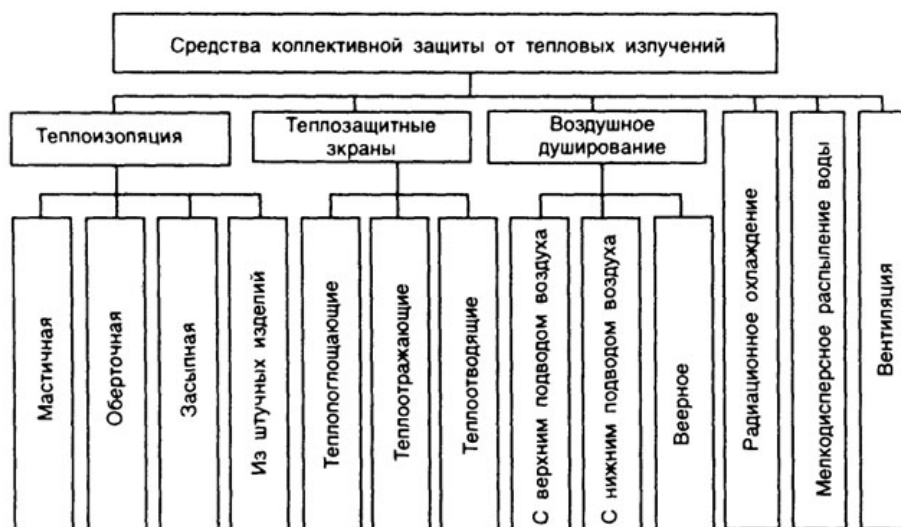
Рис. 13.4. Классификация средств промышленной теплозащиты
