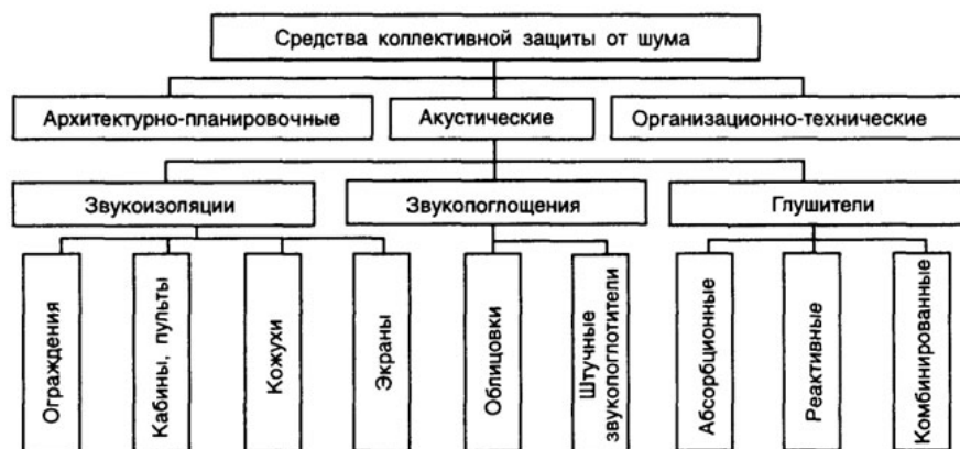
Рис. 13.1. Средства коллективной защиты от шума на пути его распространения
