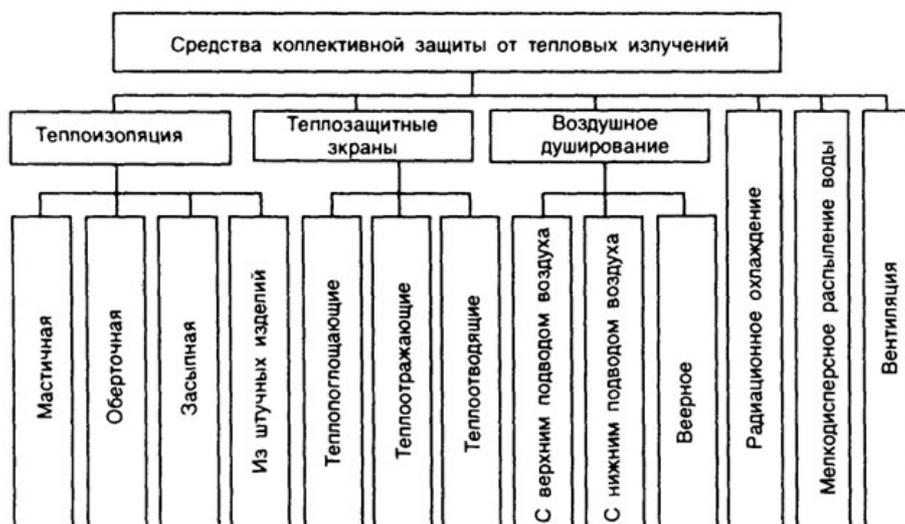
Рис. 13.4. Классификация средств промышленной теплозащиты
