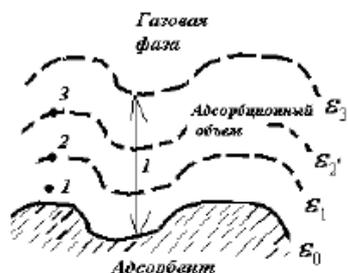
Рис. 9.2.19. Схематический разрез адсорбционной фазы по Поляни
