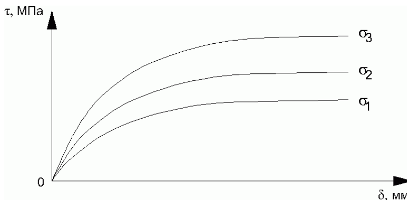
Рисунок 3.2 — График зависимости горизонтальных деформаций от касательных напряжений.
