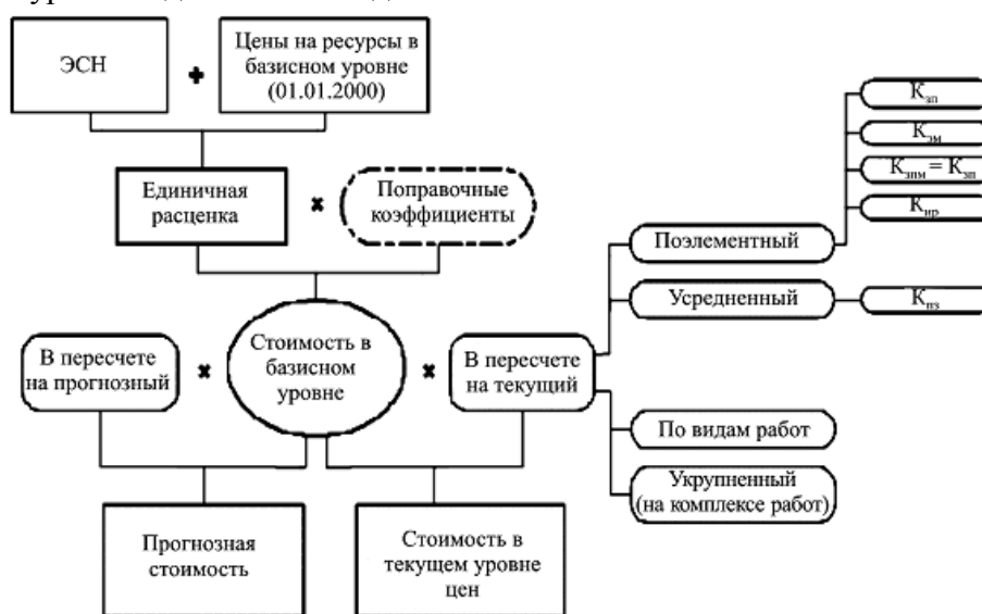
Рисунок 5. Формирование сметной стоимости строительно-монтажных работ ресурсно-индексным методом
