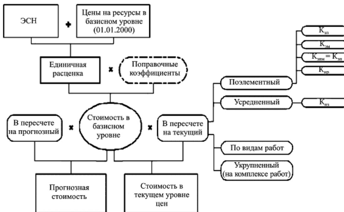
Рисунок 5. Формирование сметной стоимости строительно-монтажных работ ресурсно-индексным методом
