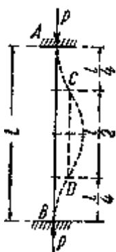
Рис.3. Расчетная схема с жесткозакрепленными торцами.
