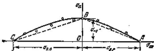
Рис.2. Диаграмма усталостной прочности.
