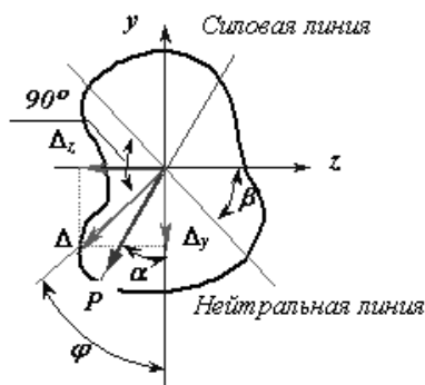
Рис.7.13. Перемещение при косом изгибе
