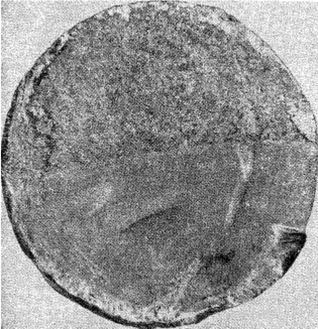
Рис.4. Характерные признаки усталостного разрушения
