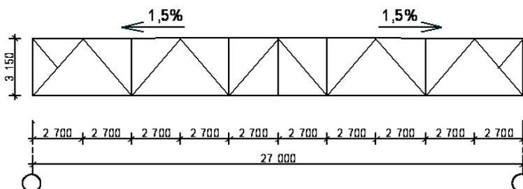
Рассчитать и законструировать стропильную ферму покрытия пролетом 27 м. Шаг ферм 8 м, сечение элементов решетки фермы выполнены из парных уголков, пояса из тавров. Покрытие теплое. Климатический район по снеговому покрову – IV. Материал фермы – сталь марки 14Г2 (ГОСТ 19282 – 73\*), соответствует марке С345 по ГОСТ 27772-88\*, соединения стержней в узлах фермы сварные, коэффициент надежности по назначению зданий 0,95. Высота фермы по наружным граням поясов 3150 мм.
