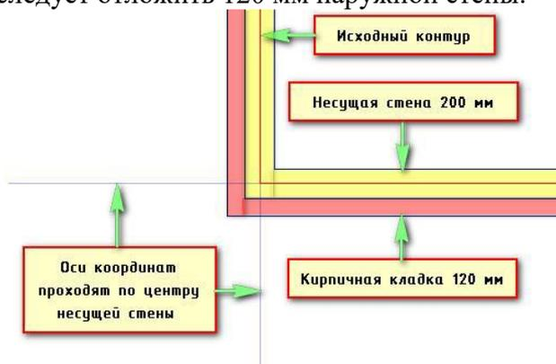
Сначала создадим стену шириной 200 мм. Для этого используем команду «Смещение». Нужно последовательно выполнить запросы:
