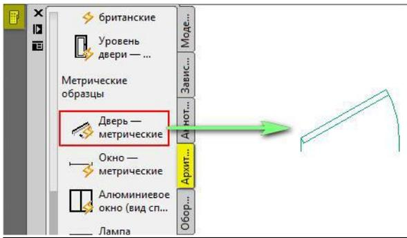
Как видно, данному блоку присвоено довольно-таки много параметров, а именно: размер двери, угол раскрытия, толщина стены и др. Все эти параметры позволяют сделать данный блок более универсальным. Его легко адаптировать под любой чертеж.
