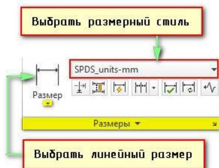
В нашем проекте размеры будем проставлять на листах. Проверьте, что бы ВЭ были не активными. Перейдите на вкладку Аннотации. Следующий важный шаг – выбрать подходящий размерный стиль. *Размерный стиль* - это именованный набор размерных параметров, управляющих внешним видом размеров, например, стилем стрелок, расположением текста и др. Т.к. мы установили СПДС, то можно выбрать уже настроенный размерный стиль SPDS\_units\_mm, который нам подойдет.
