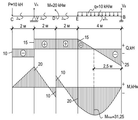
Рис. 1. Построение эпо Q и M в балке
