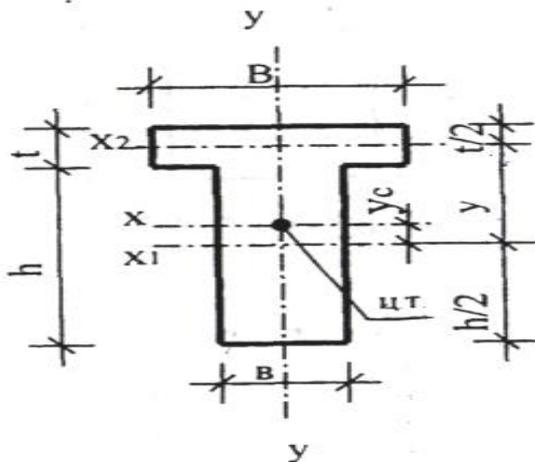
Рис.1. Тавровое сечение элемента
