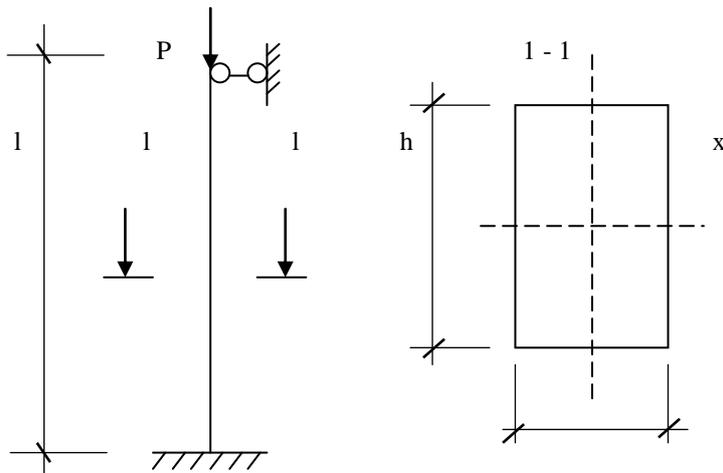
Рис. 1. Расчётная схема и поперечное сечение центрально-сжатой стойки
