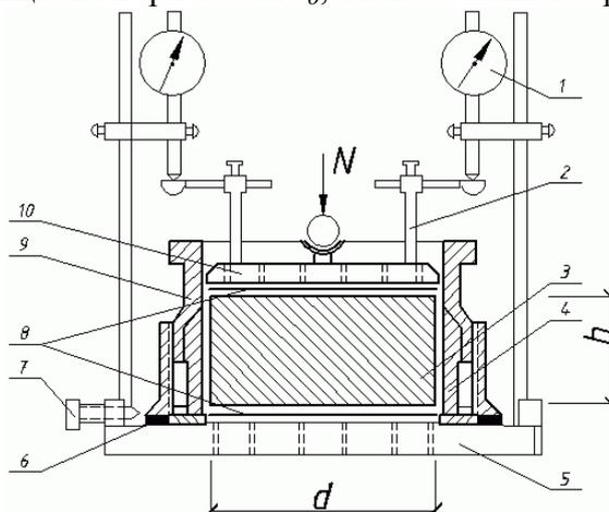
1 – индикатор часового типа; 2 – держатель индикатора; 3 – образец грунта; 4 – рабочая обойма прибора; 5 – нижний дырчатый поддон; 6 – резиновое уплотнительное кольцо; 7 – фиксирующий винт; 8 – фильтр; 9 – верхняя обойма; 10 – верхний дырчатый поршень.
