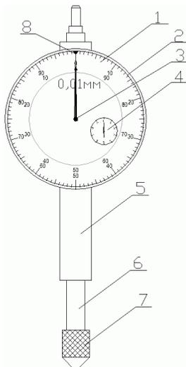
1 – циферблат; 2 – ободок; 3 – стрелка; 4 – указатель; 5 – гильза; 6 – измерительный стержень; 7 – измерительный наконечник; 8 – указатель нуля допуска.
