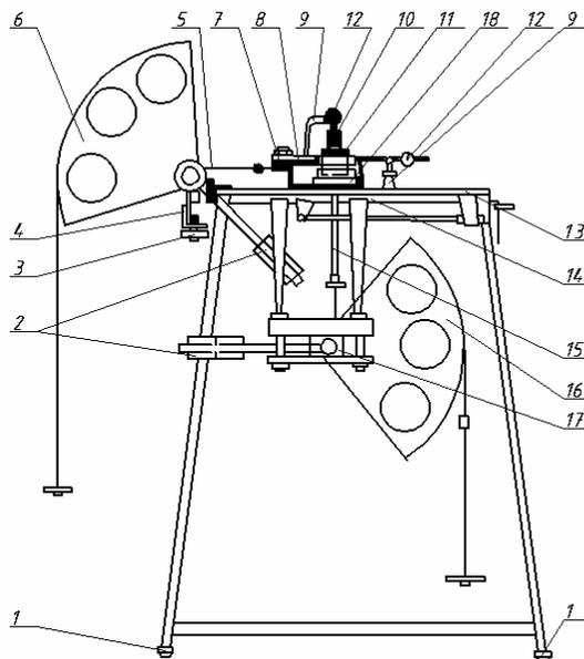
1 — подъемный винт; 2 — противовесы; 3 — тормоз; 4 — кронштейн рычага; 5 — трос горизонтальной тяги; 6 — секторный рычаг; 7 — винт; 8 — кронштейн срезывателя; 9 — держатель индикатора; 10 — упор индикатора; 11 — срезыватель; 12 — индикатор; 13 — панель рабочего столика; 14 — подвижная плита; 15 — вертикальная тяга; 16 — скользящий рычаг вертикальной тяги; 17 — ползун; 18 — ванна.
