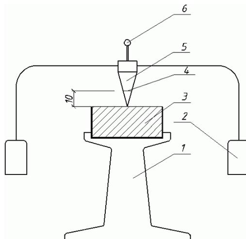
1 — подставка, 2 — два балансирных цилиндра, 3 — стаканчик с образцом грунта, 4 — метка, 5 — конус, 6 — рукоятка
