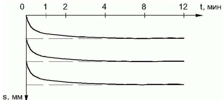
Рисунок 2.3 — График зависимости осадки  $S$  от времени  $t$
