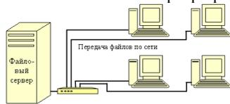
Рис. 2.1. Схема работы с БД в локальной сети с выделенным файловым сервером
