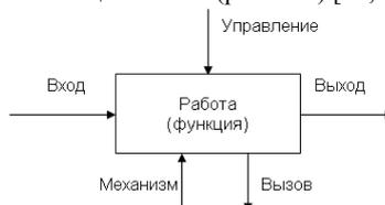
Рис. 6.1. Элементы графической нотации IDEF0
