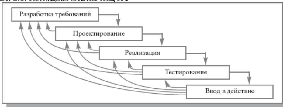
**Рис. 2.2.** Поэтапная модель с промежуточным контролем
