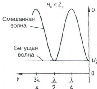
Рисунок 4.12 – Распределение амплитуд напряжения вдоль линии при соотношении  $R_H < Z_B$
