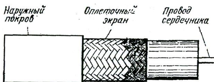
Рис.3.1. Типовой оплеточный экран
