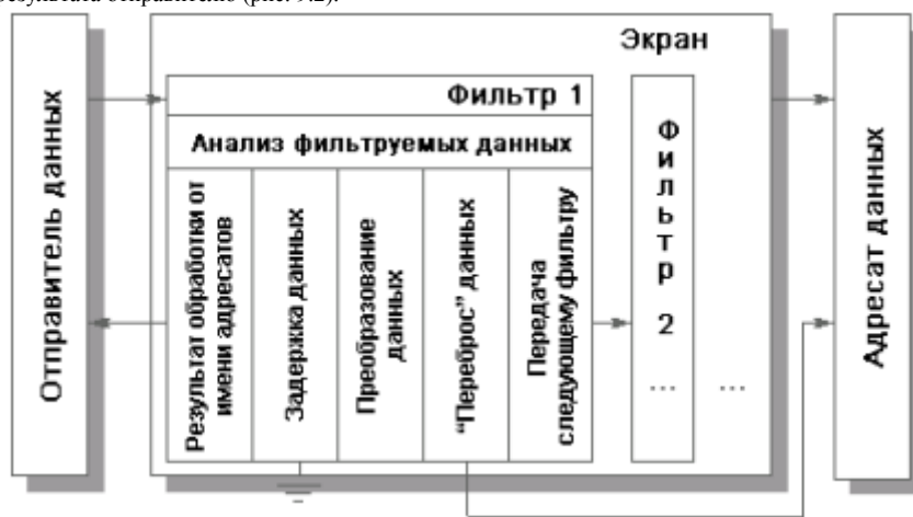
Рис. 9.2. Экран как последовательность фильтров.
