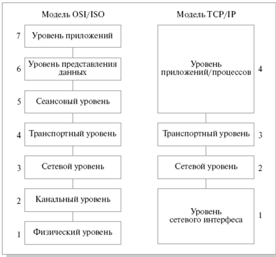
**Рис. 15-16.1.** Соотношение моделей OSI/ISO и TCP/IP
