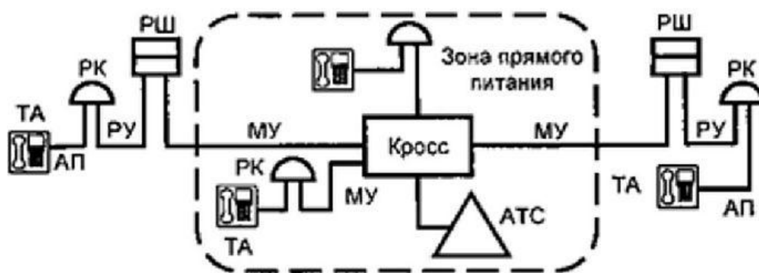
Рис. 5.1. Типовая структура аналоговой абонентской сети:
