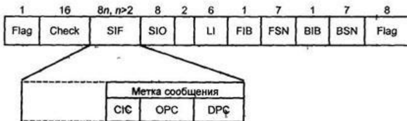
Рисунок 4.6 - Формат значащей сигнальной единицы MSU
