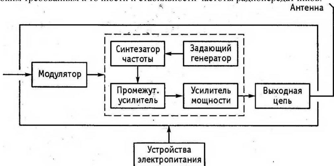
Рис. 3. Функциональная схема радиопередатчика
