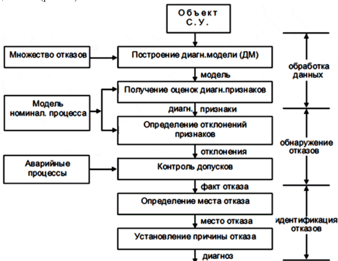
Рис. 28. Схема разработки диагностического обеспечения системы управления или объекта.
