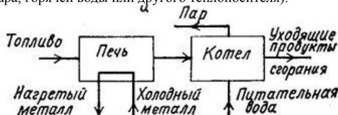
Рис. 4. Схема внешнего (разомкнутого) теплоиспользования.
