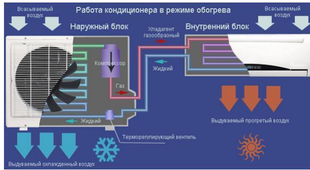
Рисунок 2 – Работа кондиционера в режиме обогрева.
