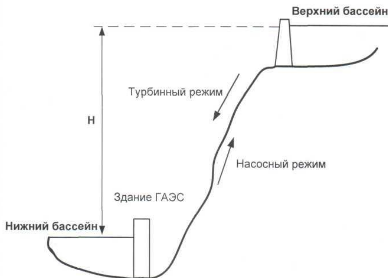
Рис.7.3. Схема создания напора ГАЭС
