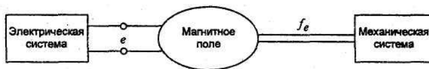
Рис. 1.1.2. Электромеханическая связь в электрической машине
