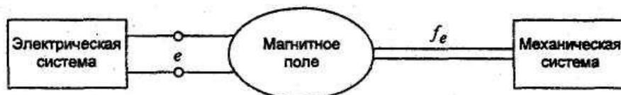
Рис. 1.1.2. Электромеханическая связь в электрической машине
