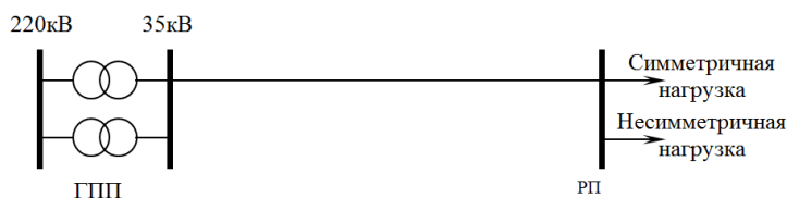
Рис.9.4. Схема неправильного подключения мощной однофазной нагрузки.
