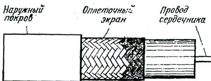
Рис. 5.1. Типовой оплеточный экран
