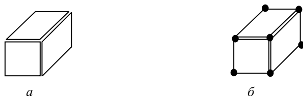
Рис. 6.13. Экранирование электрических полей: а – почти бездействующий экран с плавающими потенциалами; б – улучшение экранирования от электрических полей за счет соединений
