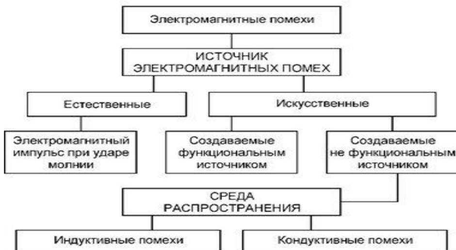
Рис. 4.4. - Классификация электромагнитных помех в зависимости от источника помех и среды распространения
