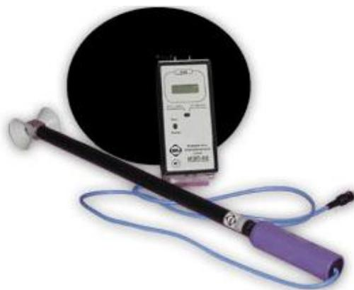
Рис. 2.2. Внешний вид измерителя электрического поля ИЭП-05
