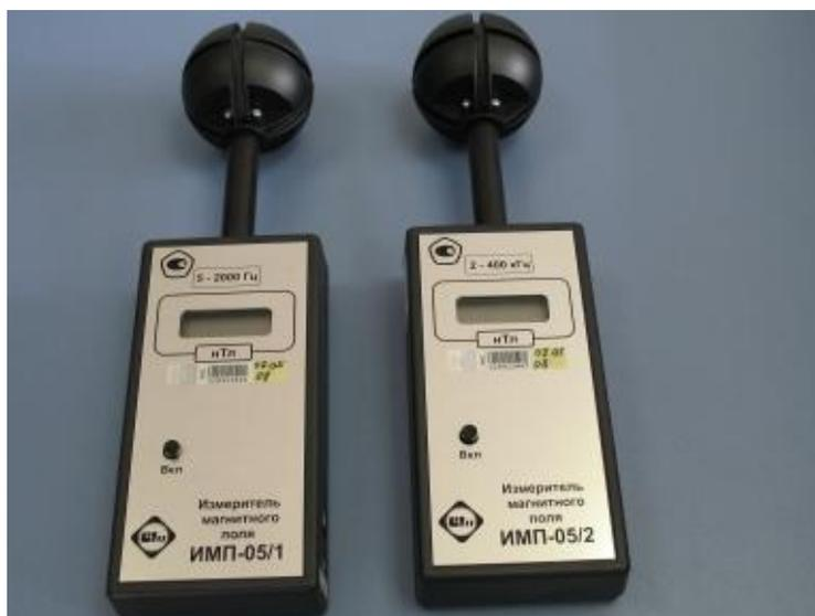
Рис. 2.4 Внешний вид измерителей переменных магнитных полей ИМП-05/1 и ИМП-05/2
