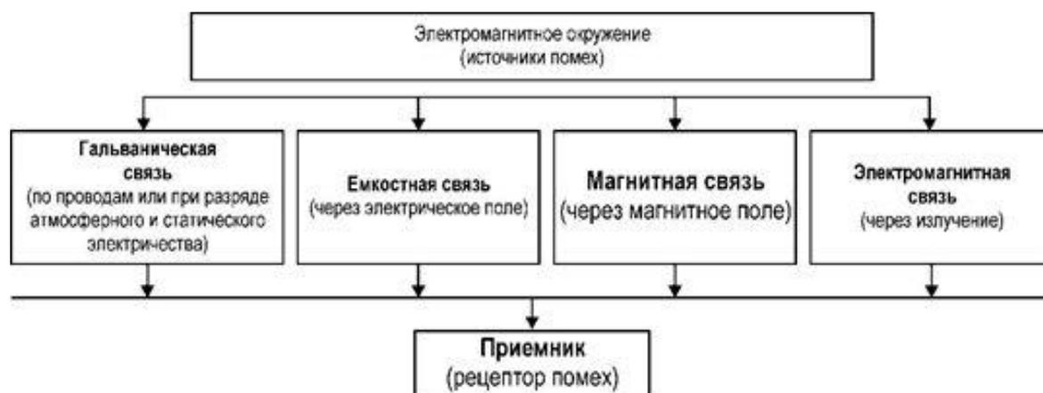
Рис. 4.2 – Механизмы связи источников и приемников помех
