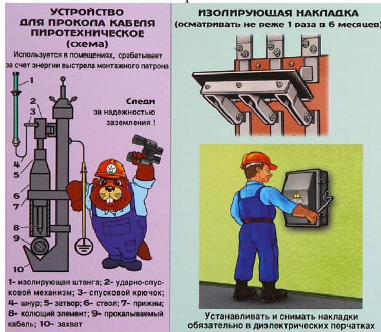
Рис. Устройство для прокола кабеля и применение изолирующих прокладок
