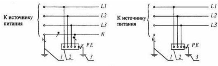
Рис.2.8. Система заземления ТТ
