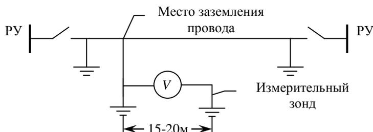
Рис. 4.6. Схема измерения наведенного напряжения на проводе отключенной ВЛ
