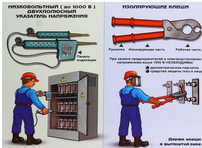
Рис. Указатель напряжения и изолирующие клещи
