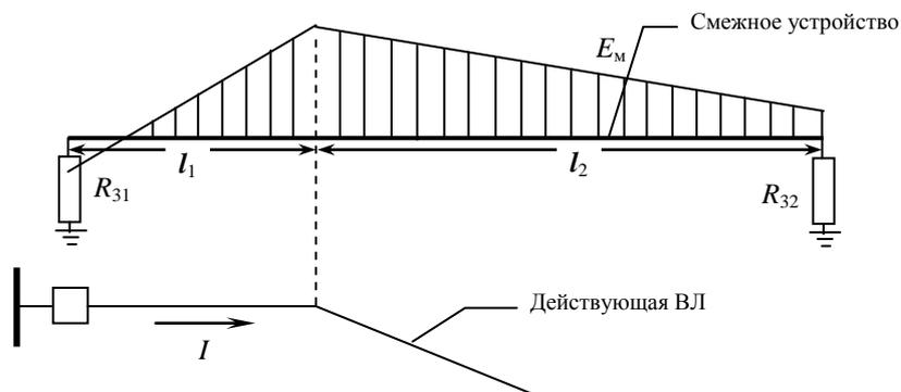
Рис. 4.4. Эюра распределения ЭМН ( $E_M$ ) вдоль смежного устройства
