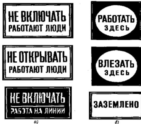
Рис. Переносные плакаты: а – запрещающие, б – разрешающие и указательный
