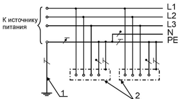
Рис.2.5. Система заземления TN-C-S
