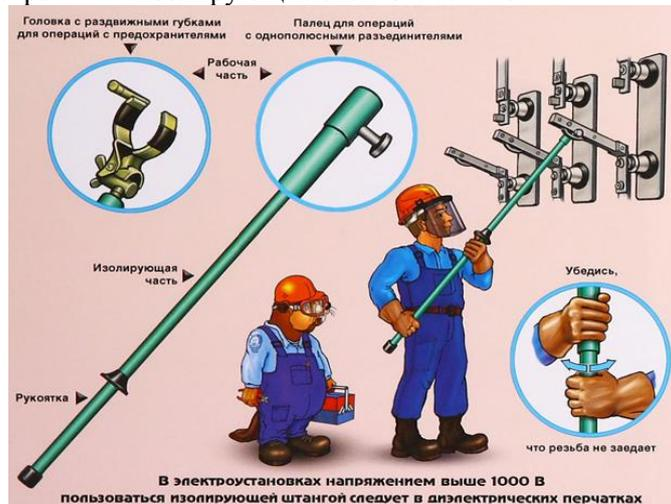
Рис. Оперативная изолирующая штанга
