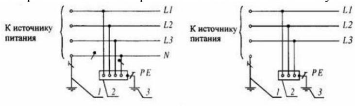
Рис.2.7. Система заземления ТТ
