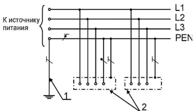
Рис.2.4. Система заземления TN-C
