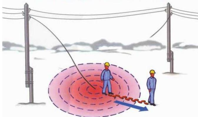
Рис.1.6. Обрыв и падение на землю провода воздушной линии
