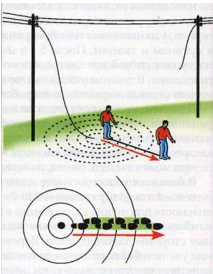
Рис.1.8. Безопасный выход из зоны шагового напряжения
