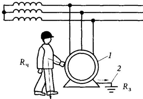
Рис. 2.2. Заземление корпуса двигателя (1 – корпус двигателя, 2 - заземление)
