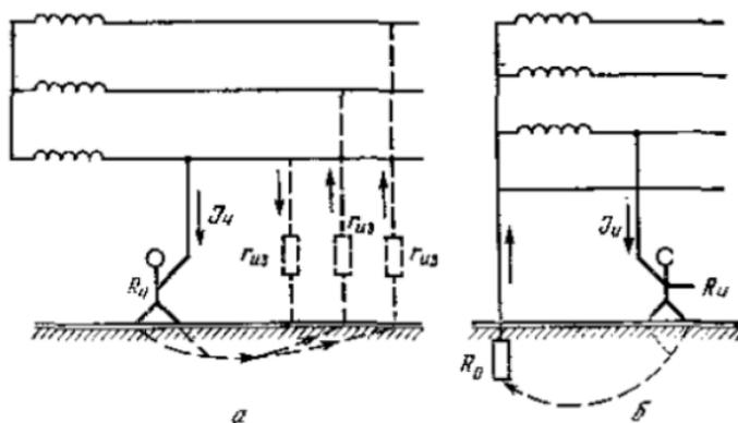
Рис. 1.3. Однофазное включение человека в сеть трехфазного тока:
