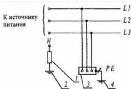
Рис.2.8. Система заземления IT
