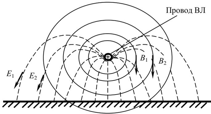
Рис. 4.1. Напряженность электрического поля ( $E$ ) и магнитная индукция магнитного поля ( $B$ ) в пространстве около провода ВЛ
