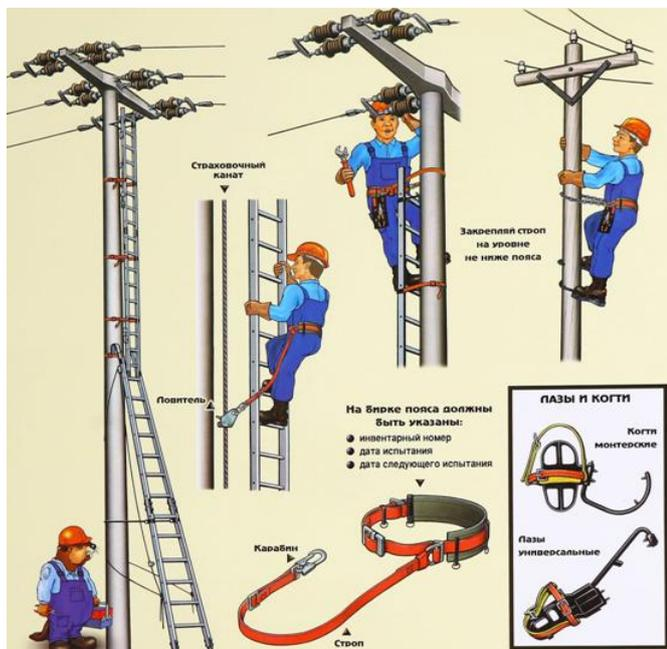
Рис. Изолирующие лестницы и предохранительные монтажные пояса
