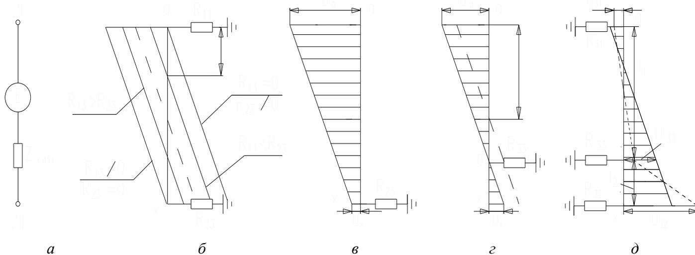
Рис. 4.5. Потенциальные характеристики провода отключенной ВЛ, находящейся в зоне электромагнитного влияния действующей ЛЭП
