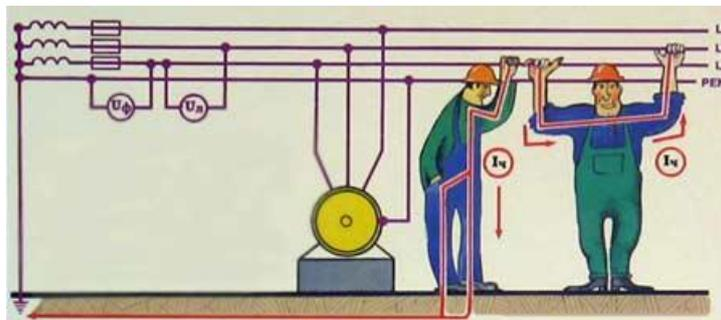
Наибольшее число электротравм связано с однофазным включением, при котором на протекающий через человека ток влияют режим нейтрали сети, качество изоляции проводов сети, ее протяженность и ряд других параметров. Однофазное включение наблюдается весьма часто: работа под напряжением при отсутствии защитных средств, при пользовании приборами с плохой изоляцией токоведущих частей, при переходе напряжения на металлические части оборудования, лишенного надлежащей защиты.
