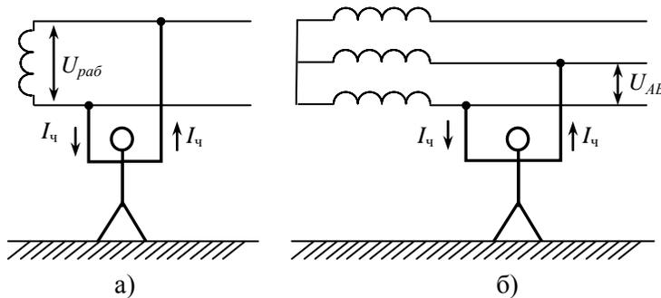
Рис. 1.4. Двухфазное включение человека в сеть: а — однофазную; б — трехфазную
