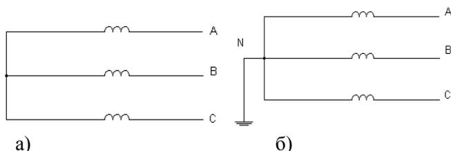
Рис.1.2. Режимы работы нейтрали электрической сети
