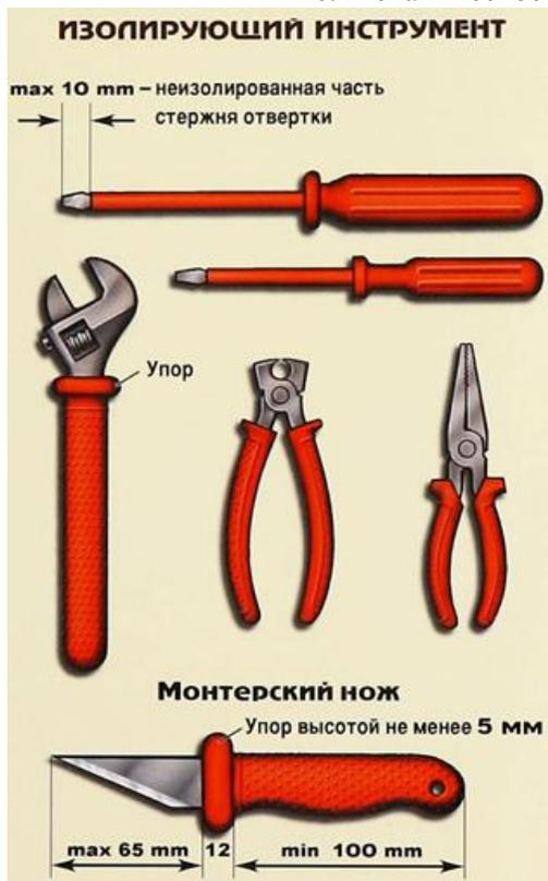
Рис. Изолирующий инструмент
