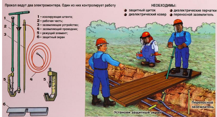
Рис. Механическое устройство для дистанционного прокола кабеля
