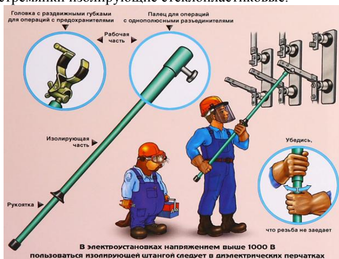
Рис. Оперативная изолирующая штанга
