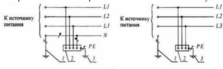
Рис.2.7. Система заземления TT
