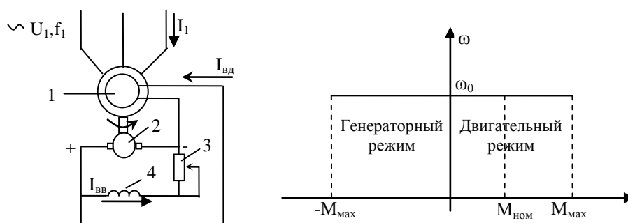
Рис. Схема включения и механические характеристики СД
