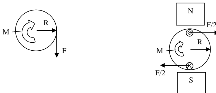
Рис. 2. Схемы формирования крутящего момента Электрический двигатель вращательного движения является источником момента.
