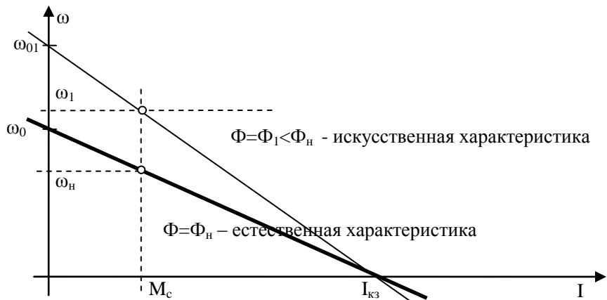
Рис. Электромеханические характеристики при различных \Phi .
