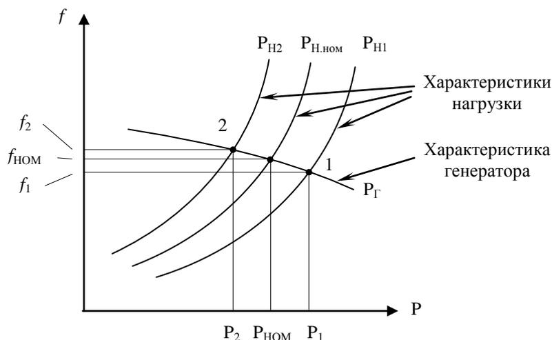
Рис.2. Статические характеристики нагрузки и генератора по частоте.
