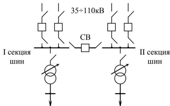
Рис.19. Схема подстанции с одной секционированной системой шин.
