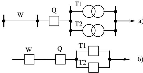
Рис.14. Составление схемы для расчёта надёжности электрической сети.
