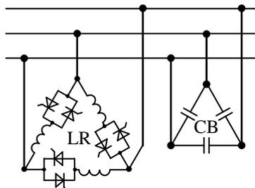
Рис.11 Схема силовых цепей СТК.
