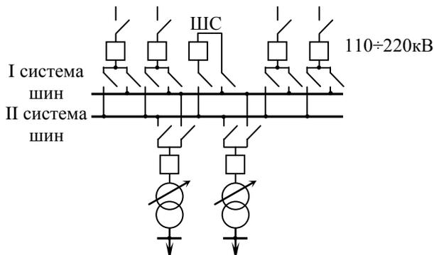
Рис.22. Схема подстанции с двумя несекционированными системами шин.
