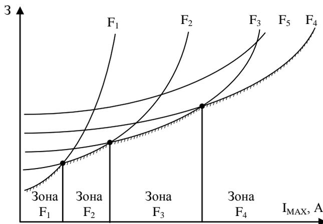
Рис.28. Зависимости приведённых затрат от максимального тока линии.
