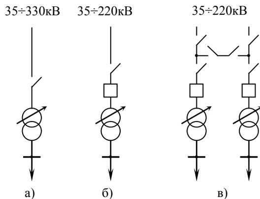
Рис.17. Блочные схемы подстанций.
