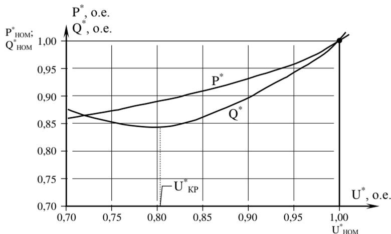
Рис.3. Статические характеристики нагрузки 110÷220 кВ по напряжению
