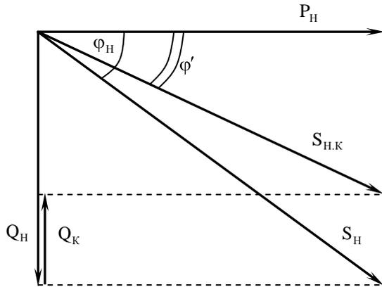
Рис.6. Диаграмма мощности при частичной компенсации реактивной мощности.
