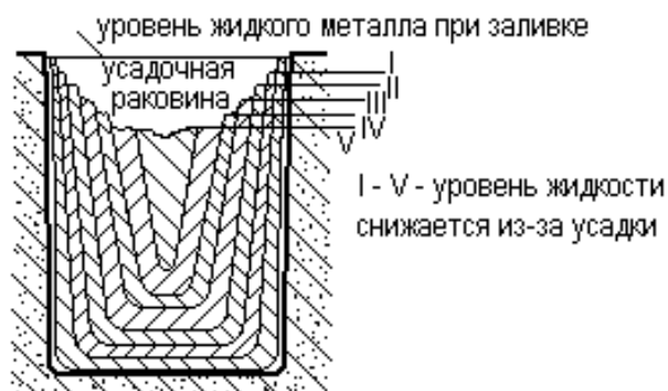
Рис. 2.2. Усадочная раковина
