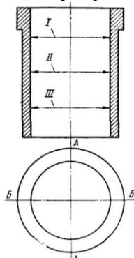
Рис. 3.2. Схема обмера отверстий в гильзе
