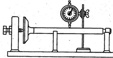
*Рис. 5.2. Проверка клапана на отклонение от прямолинейности стержня*
