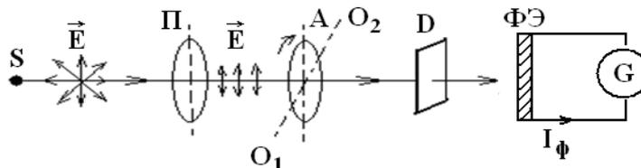
$S$  – источник света;  $\Pi$  – поляризатор;  $A$  – анализатор;
