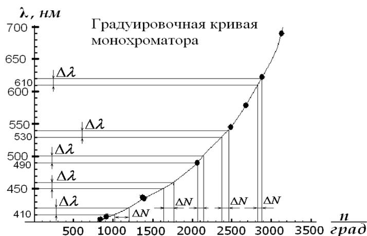
2. Переводят интервалы показаний барабана  $\Delta N_{\text{бар}}, \dots^\circ$  в интервалы угла поворота диспергирующей призмы  $\Delta\varphi''$ , учитывая, что  $2^\circ$  по барабану соответствуют  $20''$  поворота призмы. Тогда  $\Delta\varphi'' = 10 \cdot \Delta N_{\text{бар}}$ . Затем переводят секунды в радианы:  $1'' = 4.84 \cdot 10^{-6} \text{ рад}$ .
