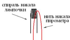
3. Медленно вращая кольцо 3 пирометра, изменяют яркость нити пирометра до тех пор, пока средний участок нити эталонной лампы не сравняется с яркостью нити испытуемой лампы (их яркости станут одинаковыми и поэтому нити станут трудноотличимыми). В этот момент производят отсчет по нижней шкале пирометра значения яркостной температуры нити лампы.
