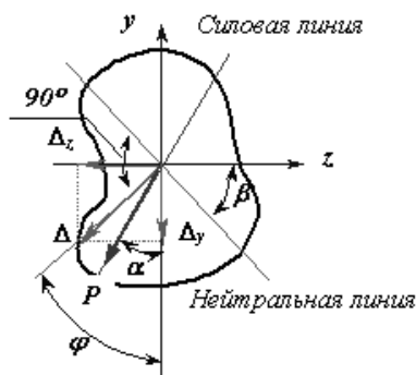
Рис.7.13. Перемещение при косом изгибе
