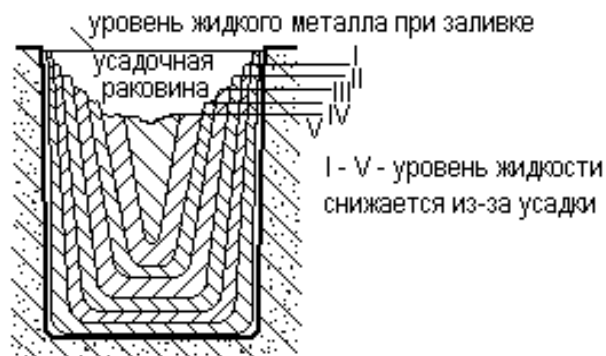
Рис. 2.2. Усадочная раковина
