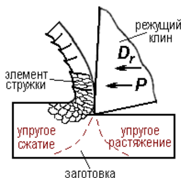
Рис. 5.1. Процесс образования стружки
