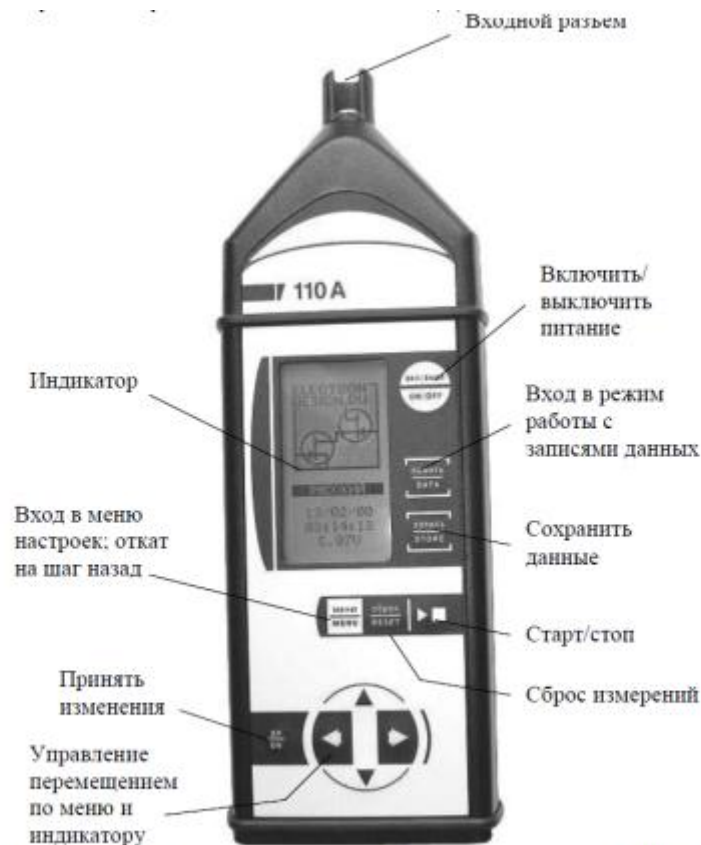
Рис. 4. Внешний вид и описание клавиш шумомера ОКТАВА-110А
