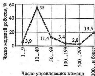
Распределение роботов с позиционной системой управления в зависимости от числа управляющих команд
