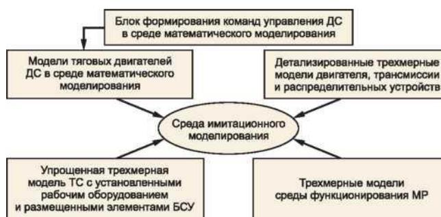
Упрощенная структурная схема синтеза математического и имитационного моделирования
