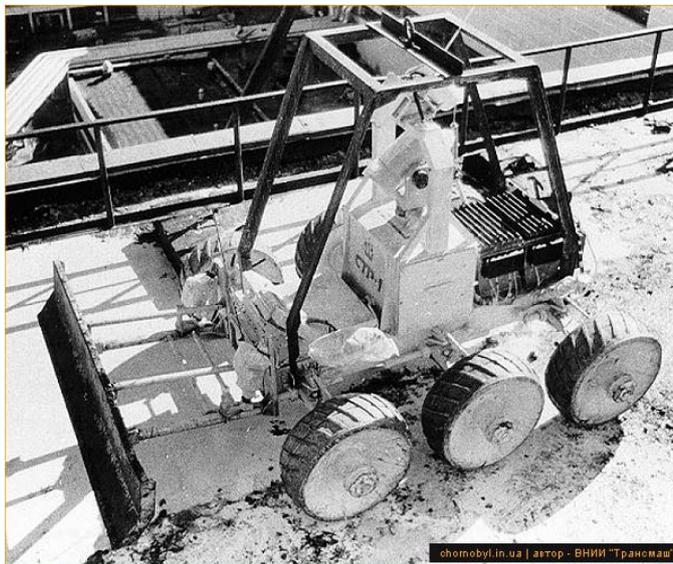
Фото: робот СТР-1 на кровле ЧАЭС (блок В)
