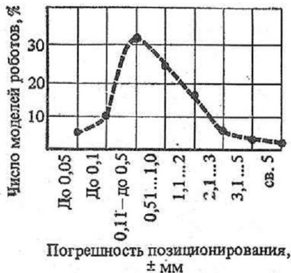
Распределение моделей роботов в зависимости от погрешности позиционирования
