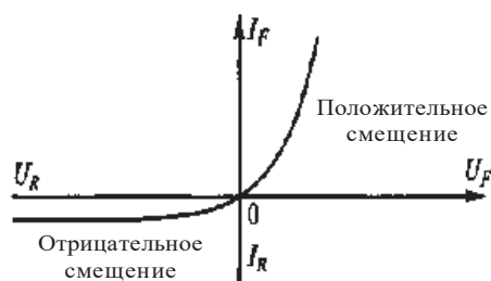
Рис. 3.1.5. Вольт-амперная характеристика идеального p - n -перехода
