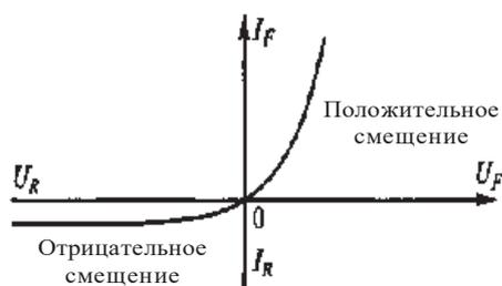
Рис. 3.1.5. Вольт-амперная характеристика идеального  $p$ - $n$ -перехода
