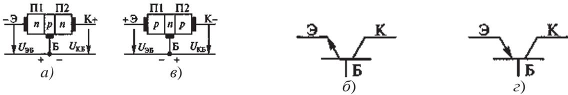
Рис. 3.2.4. Структура и графическое обозначение транзисторов:
